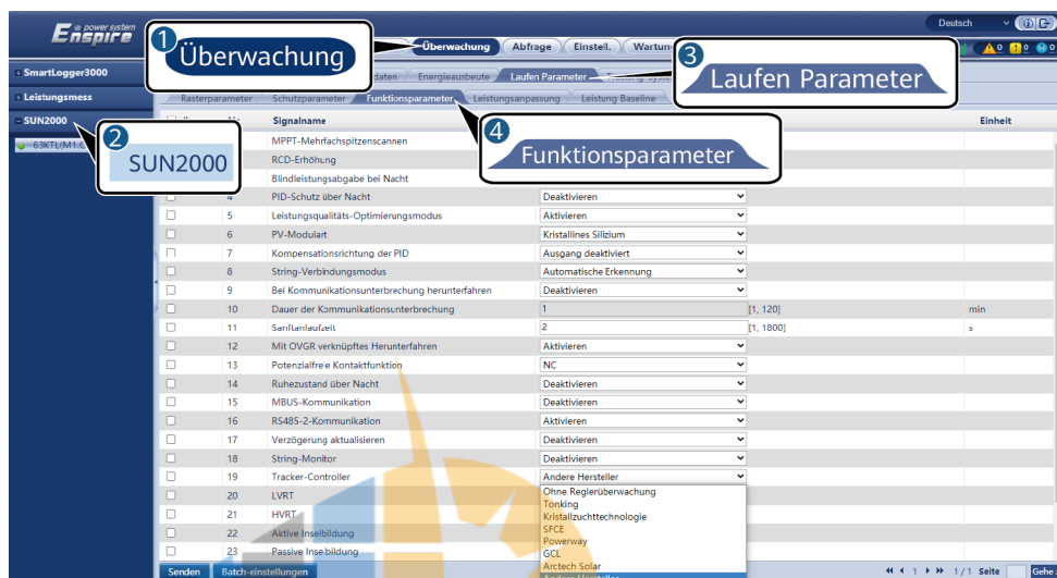
Abbildung 6-42 Einstellen des Tracking-System-Controllers
