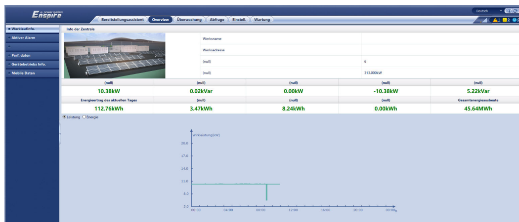
Abbildung 6-3 Betriebsinformationen einer Anlage (mit Leistungsmesser, aber ohne Akku)
