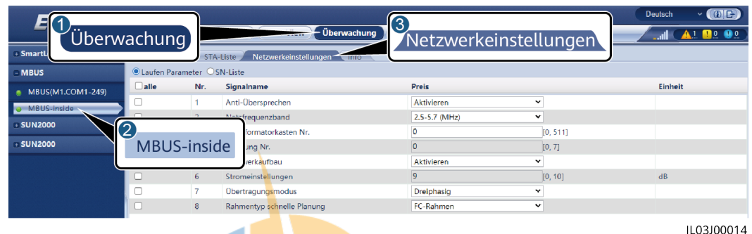
Abbildung 6-38 Einstellen des integrierten MBUS-Netzwerks
