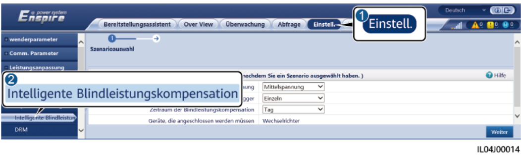
Abbildung 6-84 Einstellen der Parameter für die intelligente Blindleistungskompensierung
