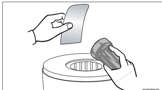
59. Abbildung Überprüfung der Verschmutzung des Wärmetauscherblocks
