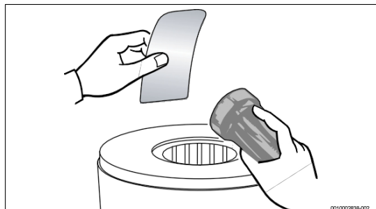
59. Abbildung Überprüfung der Verschmutzung des Wärmetauscherblocks
