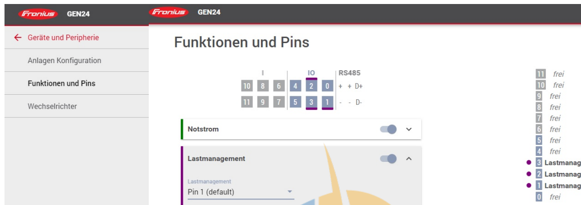
Abbildung 7 - Lastmanagement Ausgänge unter dem Punkt Funktionen und Pins aktivieren.
