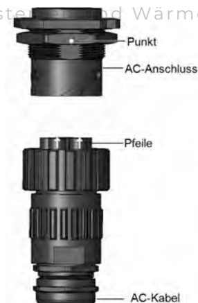
Abbildung 16: Verbindung des AC-Anschlusses mit einer Sekundäreinheit
