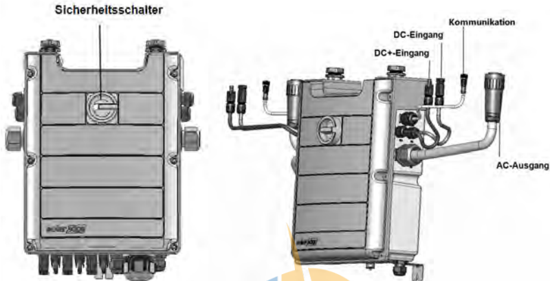
Abbildung 9: Vorderseite der Anschlusseinheit und seitliche Schnittstellen
