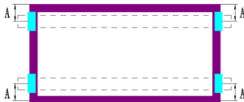
Verwenden Sie 4 Klemmen an der kurzen Seite. Die Montageschienen verlaufen parallel zur Längsseite des Rahmens.
