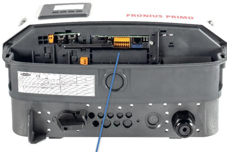
Abbildung 3: 16-poliger Stecker an SnapINverters (Primo, Galvo, Symo, Eco). Die Pins IO 0–3 und GND (-) dienen zur Ansteuerung des externen Relais.
