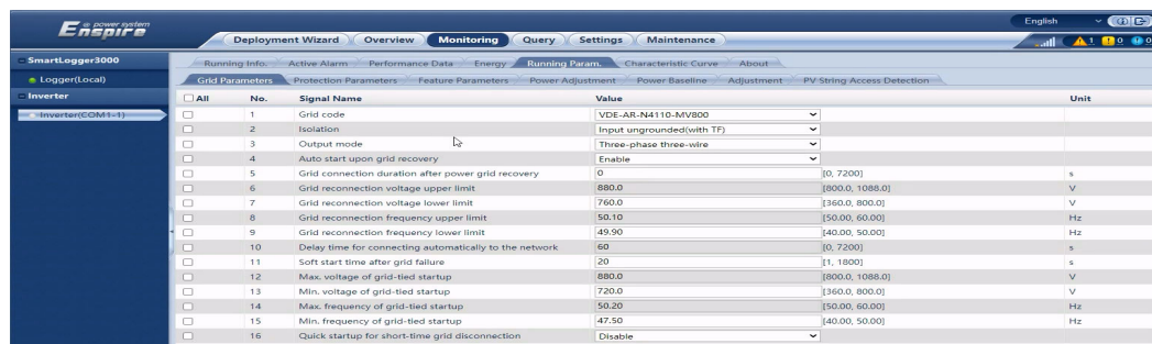
Abbildung 7-14 Einstellen der Betriebsparameter
