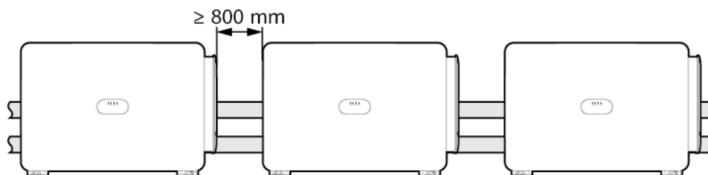
Abbildung 4-5 Horizontale Montagemethode (empfohlen)
